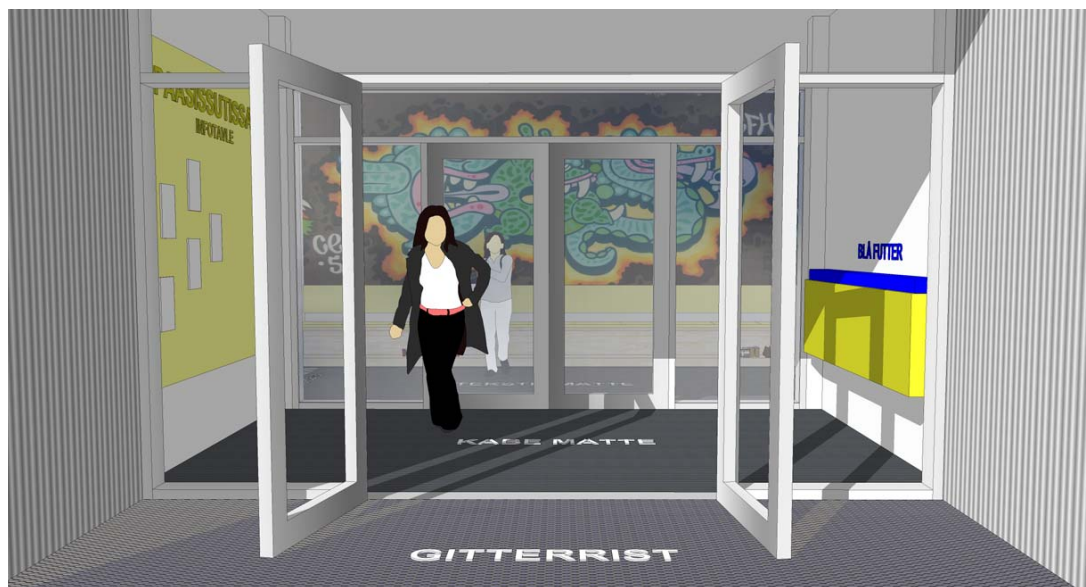
Indgangsparti med overdækket indgang, vindfang og skosluse
